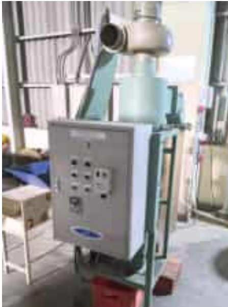
Figura 48. Máquina separadora neumática, empleada para la selección de semillas de tomate (Sipe Sipe, Cochabamba).
