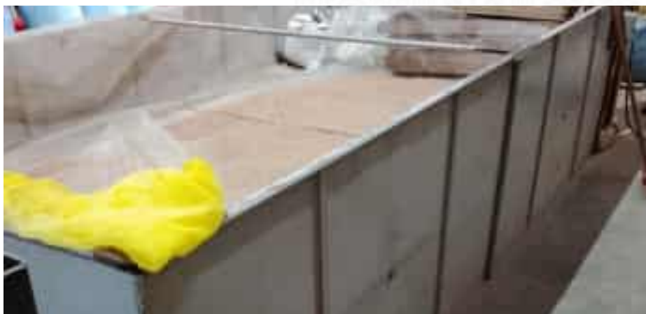
Figura 44. Secadora horizontal de semilla (Sipe Sipe, Cochabamba).
