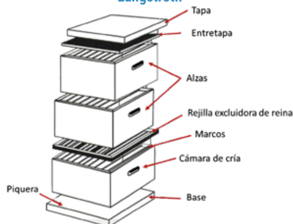
Figura 1. Partes de una caja apícola estándar Langstroth
