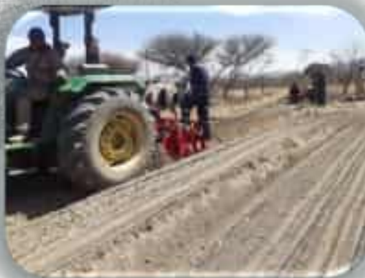
Figura 3. Preparado de camas para la implementación de parcela de validación con implemento agrícola (encamadora) del proyecto hortalizas.
