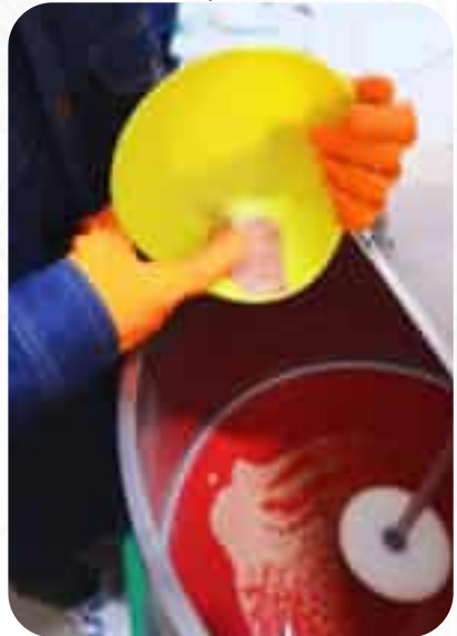
Figura 28. Tambor giratorio del equipo de peletizado.
