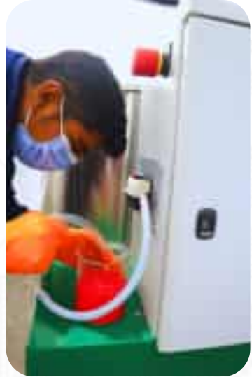
Figura 27. Conexión de la manguera de succión, solución líquida.
