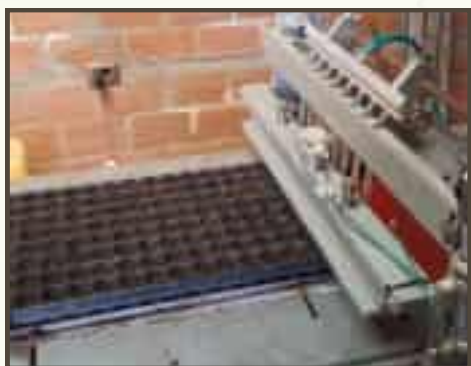
Figura 16. Sembradora de semillas de tomate semiautomática.
